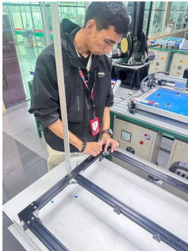
ภาพที่ 3.1 ประกอบโครงสร้างเครื่องตัดโฟมอัตโนมัติ
