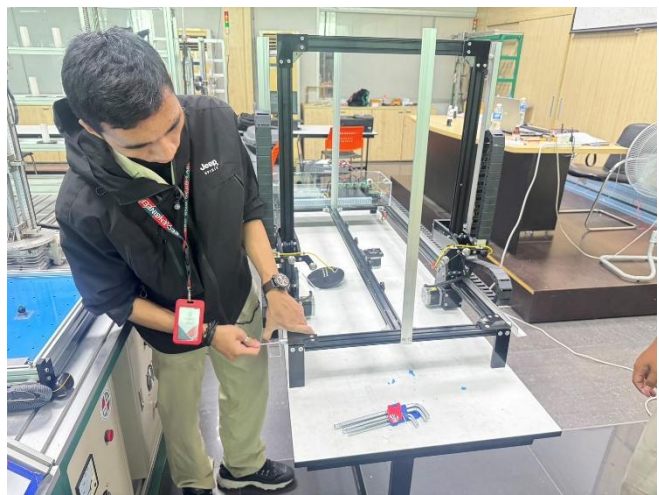
ภาพที่ 3.1 ประกอบโครงสร้างเครื่องตัดโฟมอัตโนมัติ
