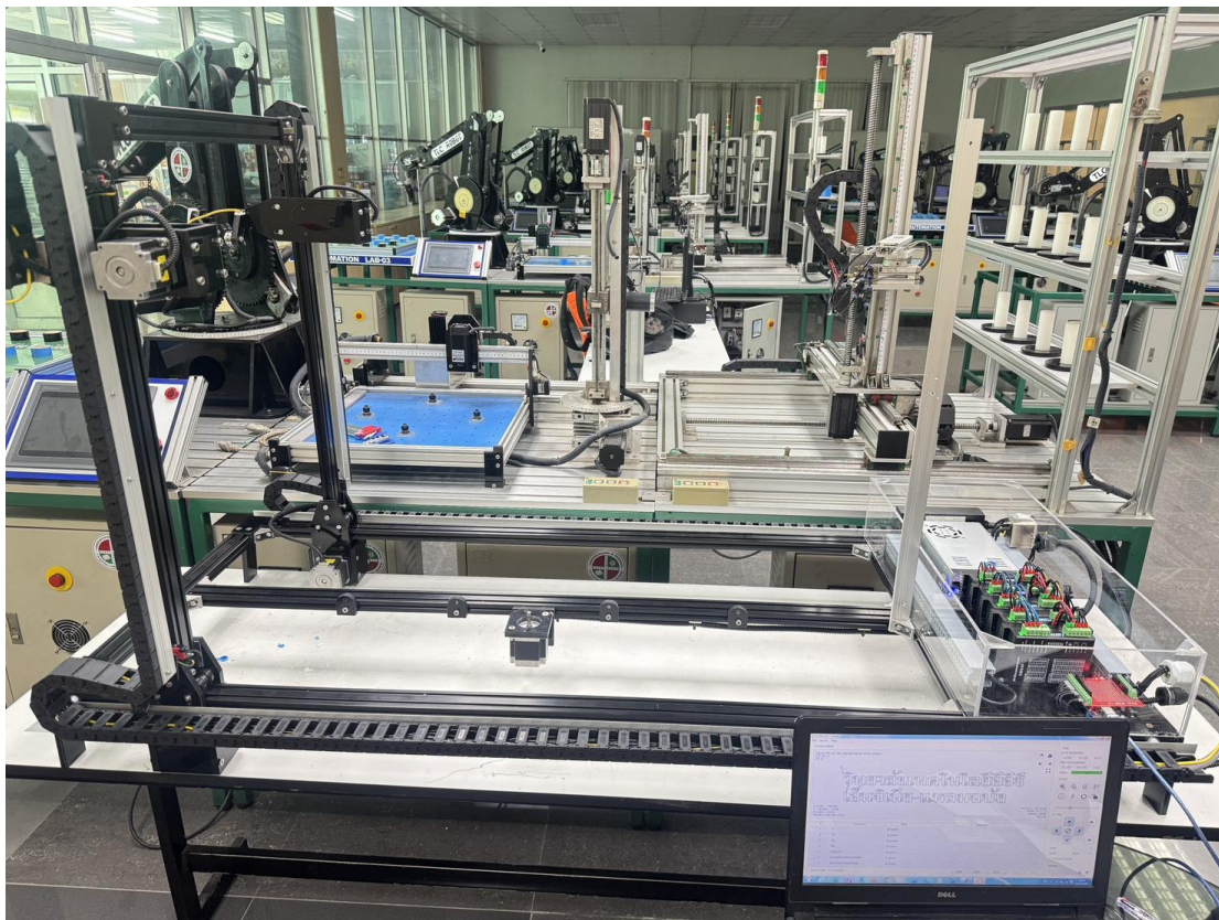
ภาพที่ 3.5 เครื่องตัดโฟมอัตโนมัติที่ประกอบติดตั้งสำเร็จ
